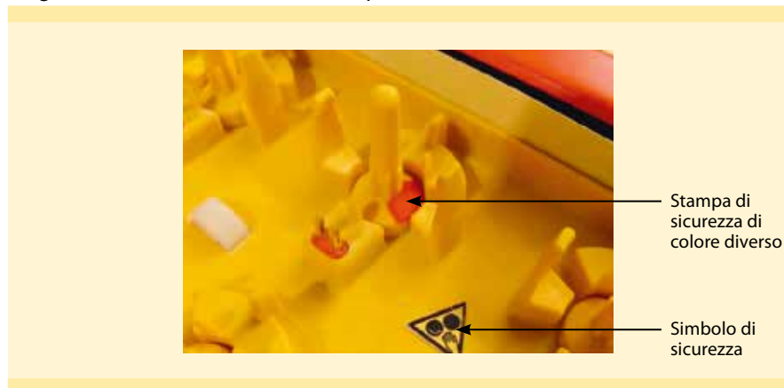
Figure 1: Simbolo di sicurezza sul fondo della vaschetta del gentleMACS Octo Dissociator with Heaters.
