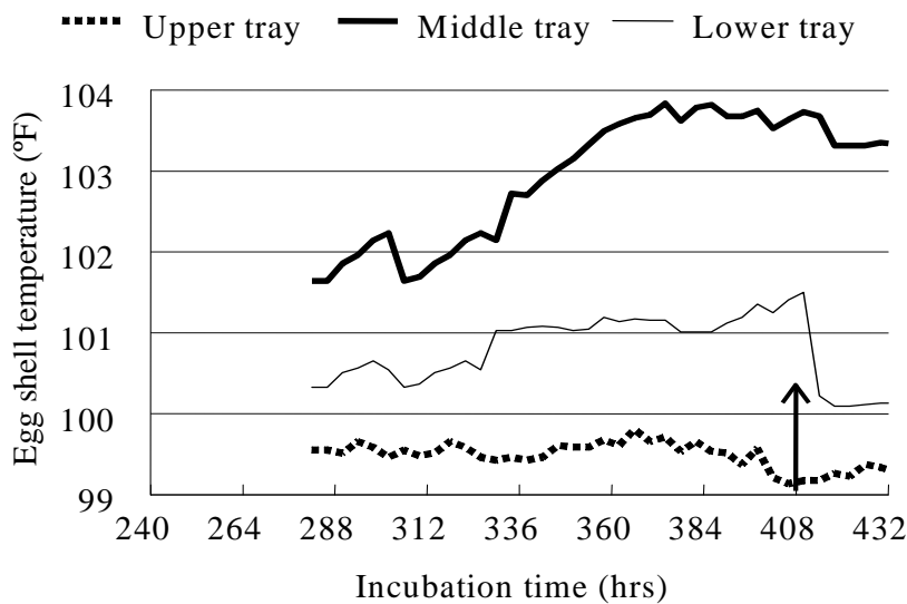
Figure 2 Egg shell temperatures in a commercial single stage setter (Praktijkonderzoek Pluimveehouderij 99/1)
